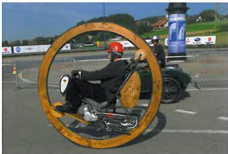
Interessante Konstruktion: Das Einrad von Martin Maurer wird von einem Mofamotor angetrieben.
